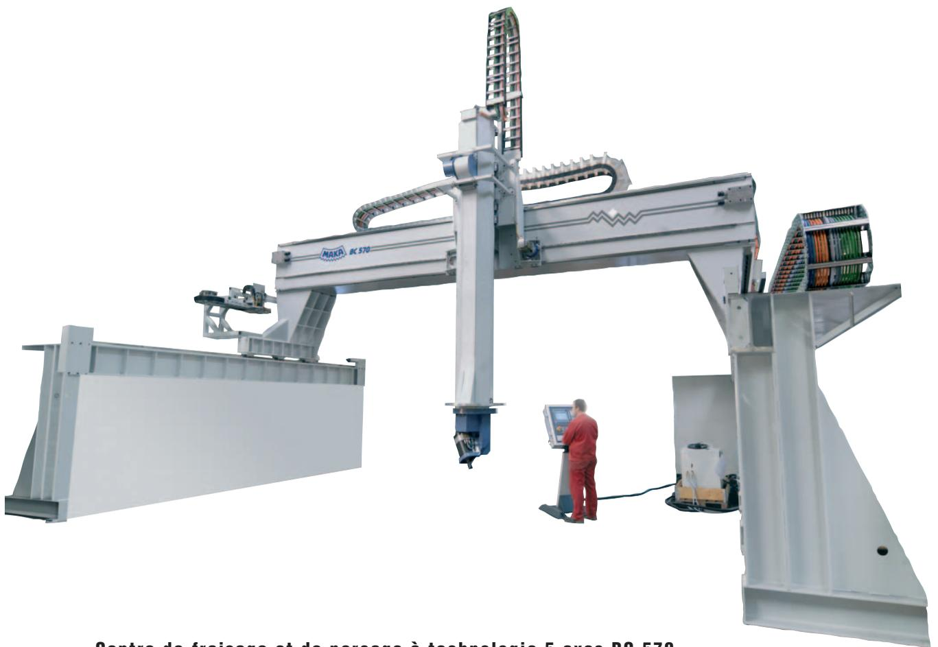
**Centre de fraisage et de perçage à technologie 5 axes BC 570**
