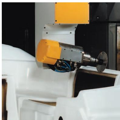
**Usinage de matières plastiques renforcées par fibres de verre dans la construction navale**
